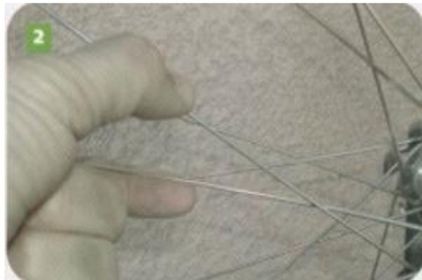
**Etape 5** - Faites à nouveau tourner la roue et reprenez le réglage au point 3 si vous constatez encore des défauts.
